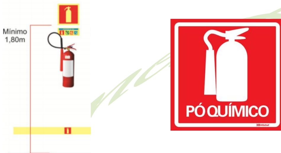
Detalhe de instalação do Extintor de Incêndio
